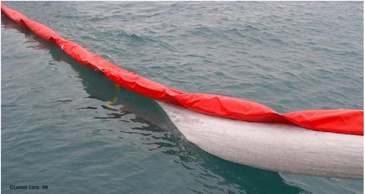
Der SILT CURTAIN wurde als Anbauteil für konventionelle Ölsperren entwickelt, um treibenden Schlick oder bei Unterwasserarbeiten aufgewirbelte Sedimente einzugrenzen, die sich in Tiefen bewegen, die herkömmliche Ölsperren nicht abdecken können.
