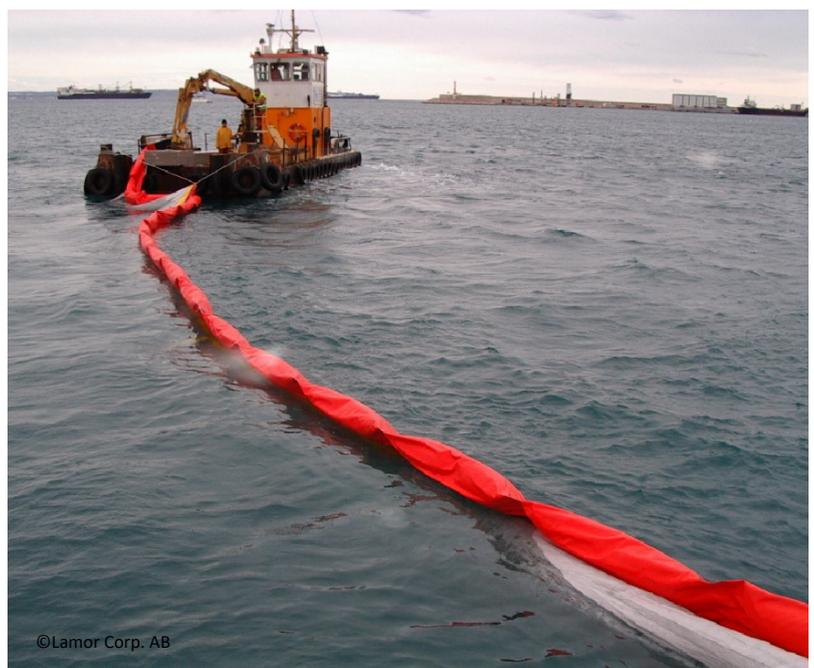
Der SILT CURTAIN ist in die Ballastkette der Ölsperre eingeschäkelt (Fig.1). Die Ölsperrensegmente werden mit den international gebräuchlichen ASTM-Schnellkupplungen verbunden, die Schürzen-Segmente untereinander ebenfalls mit Schäkeln (Fig.2).
